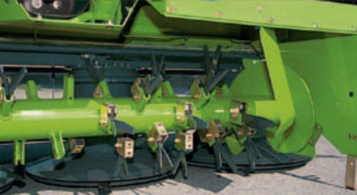
Il grado di condizionamento può essere adeguato senza attrezzi attraverso la regolazione del deflettore. Ruotando i denti asimmetrici di 180° è possibile variare nuovamente il grado di condizionamento. Le lamiere andanatrici depositano l'andana nella larghezza ottimale.
