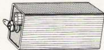
Fig. 19 - Elementi rettangolari, con contenitore in acciaio nichelato.
